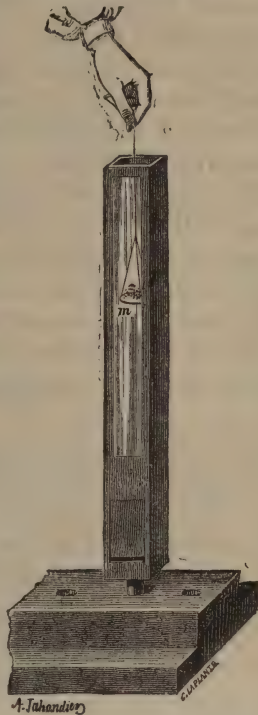
Fig. 20. — Vibrations de la colonne gazeuse d'un tuyau sonore.
